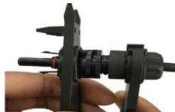
FIG. 7-17 Aperte o prensa-cabo
