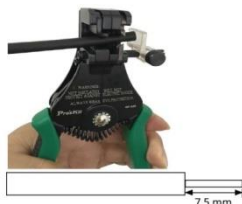
FIG. 7-14 Tira a camada isolante do cabo
