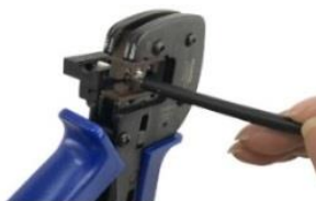
FIG.7-15 Desencape o contato
