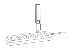
Nota: Não instale o DTU diretamente acima do metal ou concreto para evitar a diluição do sinal.
